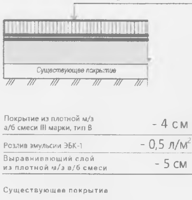
Конструкция дорожной одежды местного проезда
